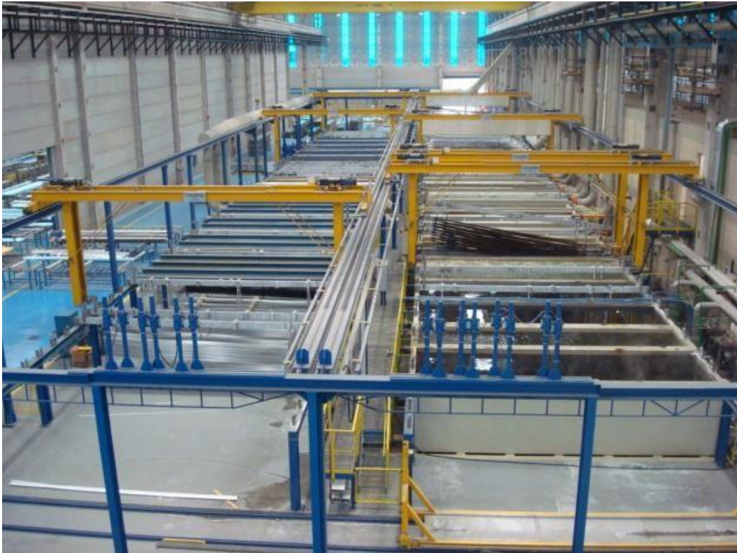
Figura 3: planta de anodização 1000 t da VM/CBA – Projeto VM/CBA e Italtecno.
