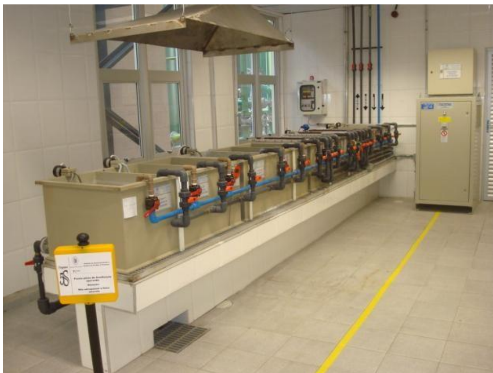
Figura 6: Planta piloto de anodização na unidade de desenvolvimento de processo e produto.
