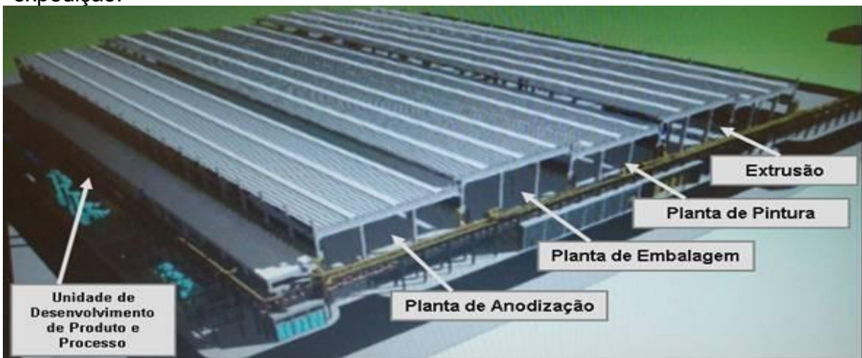
Figura 13: Vista em 3D do todo o complexo integrado, prensas de extrusão, planta de pintura, embalagem, e anodização
