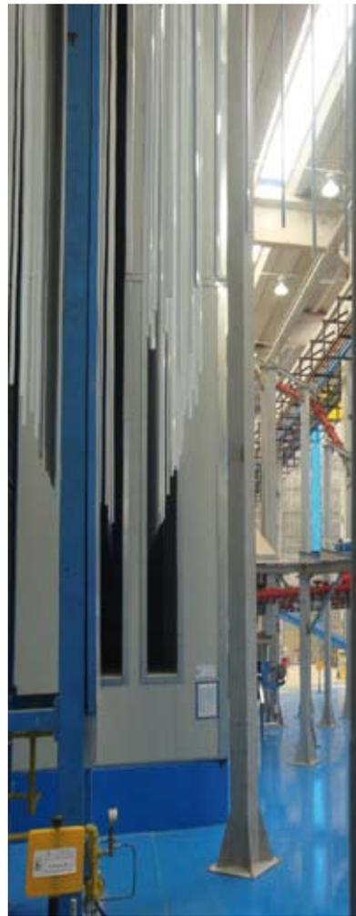
13 - Il forno di cottura delle polveri (180°C per 20 minuti).
