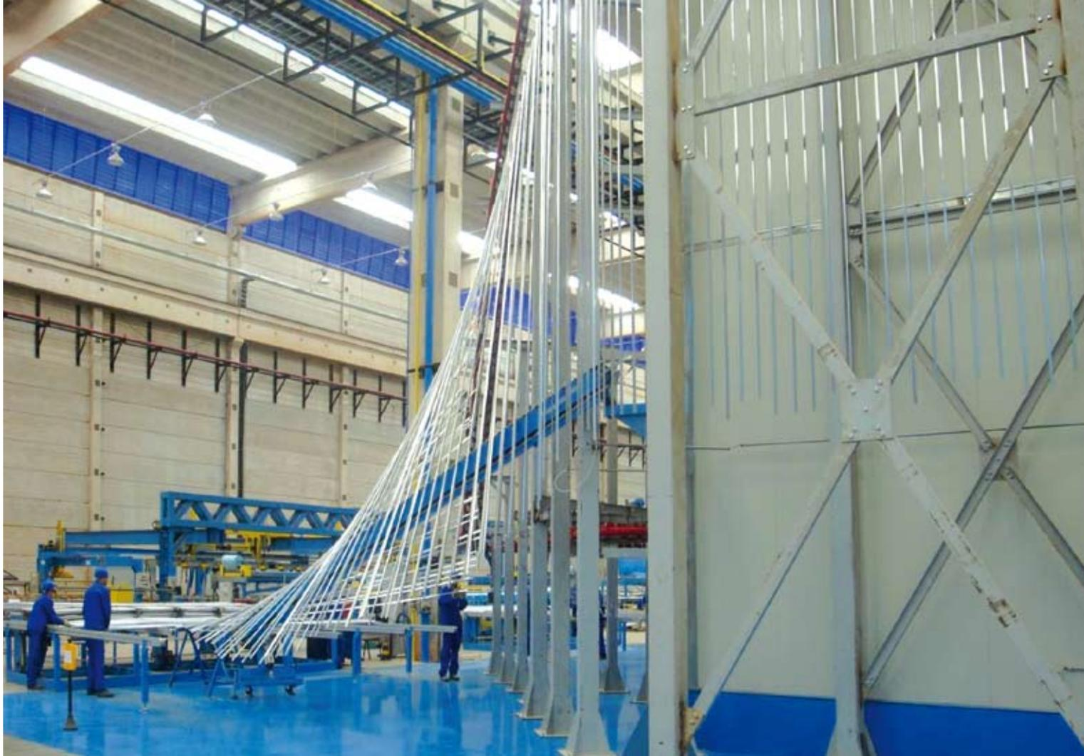
6 - Particolare della fase di carico dei profilati d'alluminio.
