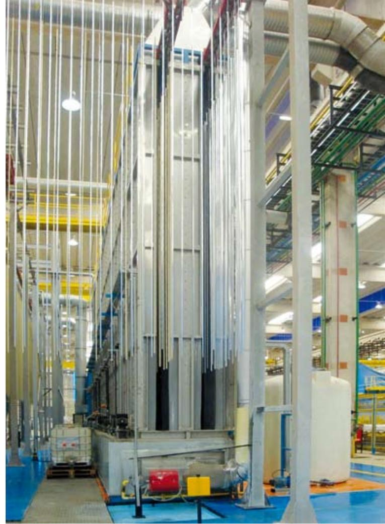
8 - Il forno di asciugatura dello strato di conversione dell'alluminio che corre parallelo con il tunnel di pretrattamento, a destra di figura.
