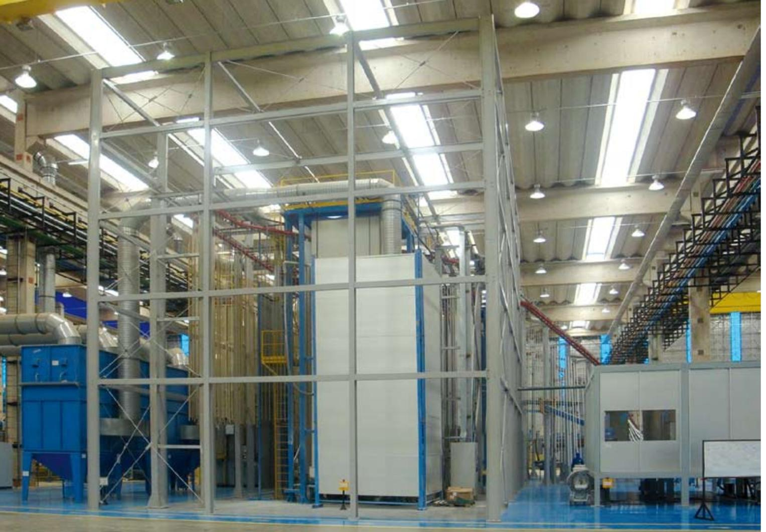
**3 - Il superimpianto di verniciatura in verticale dei profilati in alluminio, progettato, costruito e installato dalla Trasmetal di Milano.**
