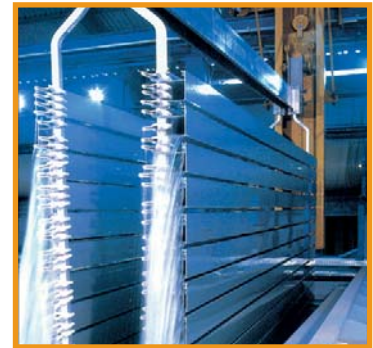
Fig. 2 - Gancheiras de perfis de alumínio com fixação através de pinças tipo alicate
